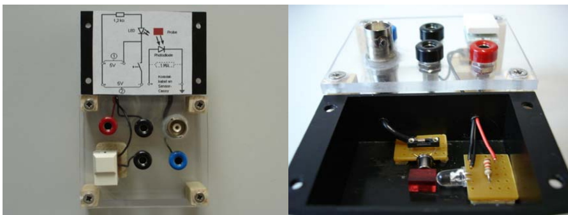
Abbildung 12: fertiger Versuchsaufbau; links: geschlossener Versuchsaufbau rechts: Einsicht in die Elektronik
